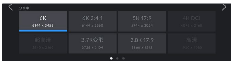
使用Blackmagic RAW编解码格式时，Pocket Cinema Camera 6K的“分辨率”选项
