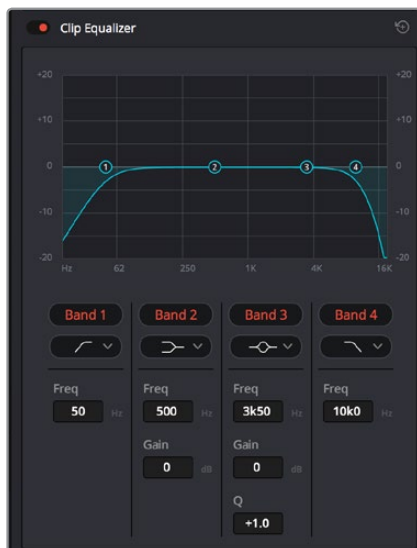
L'égaliseur à quatre bandes peut être appliqué à tous les clips de la timeline
